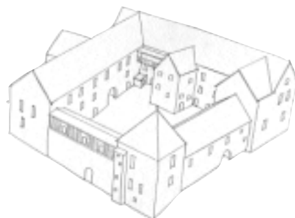
Linköpings slott under Johan III:s tid 1570-90-tal. Västra längan höjs till tre våningar. Södra flygeln och porttornet mot yttre borggården byggs. Trapptornet på inre borggården med en loftgång direkt över till rikssalen tillkommer samt två våningar av norra flygeln. En trumpetargång mellan södra flygeln och tornet byggs ovanpå ringmuren i öster.
