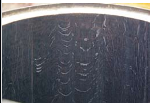
Här har elden gjort sitt. Efter ungefär 10 sekunders brinntid blir det så här vackert. Kollagret är 2–3 mm tjockt och den whisky som lagras i detta fat kommer att bli riktigt ädel.
