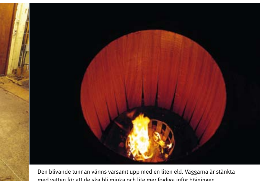
Här har elden gjort sitt. Efter ungefär 10 sekunders brinntid blir det så här vackert. Kollagret är 2–3 mm tjockt och den whisky som lagras i detta fat kommer att bli riktigt ädel.
