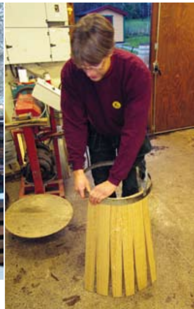
Ett ekfat i varande. Delarna pusslas samman och ska snart böjas med hjälp av värme.
