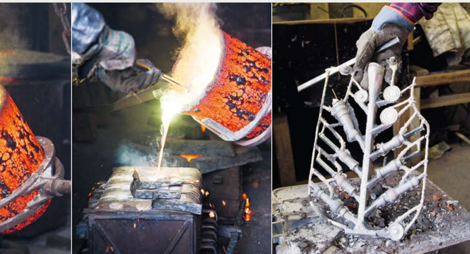
Den smälta metallen hålls i gjutflaskor.
