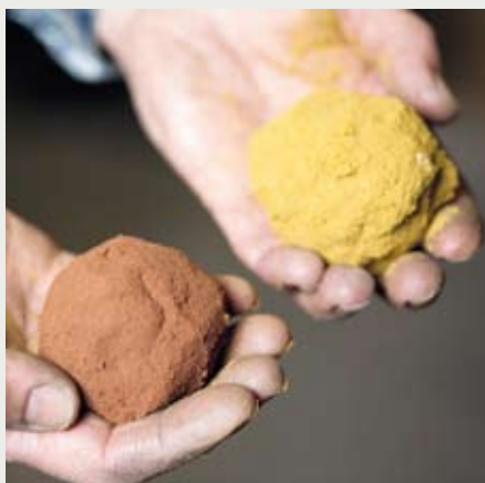
Gjutsand baserad på lera, den röda är från England och den gula är från Frankrike.
