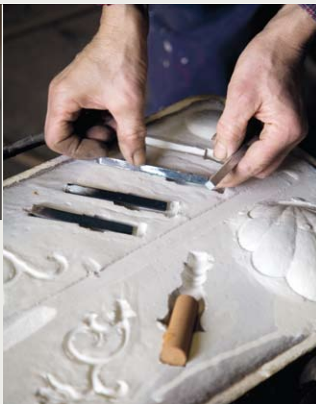
Tillverkning av gjutflaska med gjutmodeller inför gjutning.
