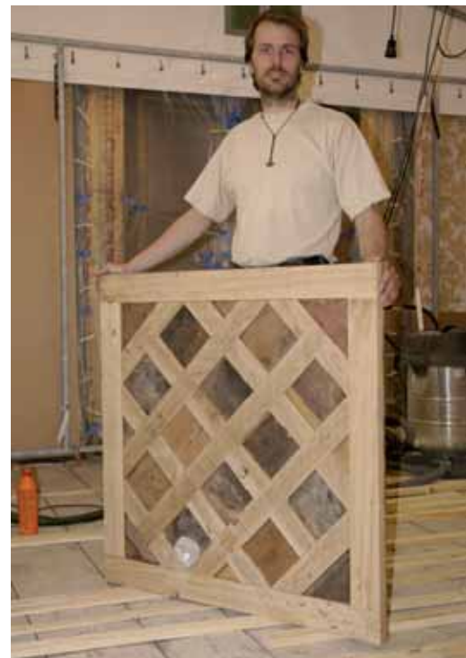
Golvet i galleriet består av 300 kvadratiske parkett-tavlor som är fästade med spånt i varandra och bildar ett vackert mönster.
