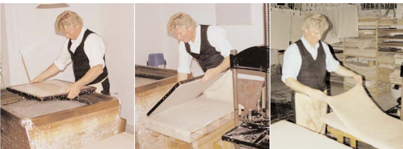
Pappersmassan 'fångas' i en träram med ett fint nät av ståltråd i botten. Sedan vattnet silats av förs massan över på en filt varpå den pressas och torkas till färdiga pappersark.
