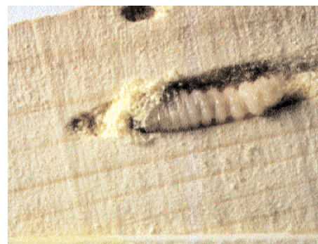
Under tiotals år kan husbocken äta sig in i splintveden innan den förpuppar sig. (Ca 2 ggr förstoring).
